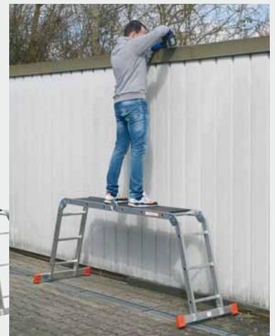
Durch Trittauflage 985/4410-H (Zubehör) auch als Arbeitsbühne mit einer Arbeitshöhe bis zu 3,0 m einsetzbar
